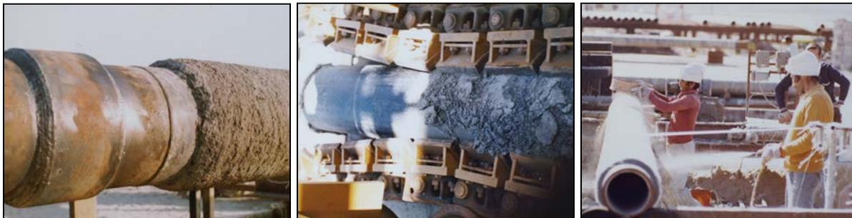
*Bredero Price Beton am Yard und im Tensioner; Aufbringen GFK Coating am Pipeyard*
