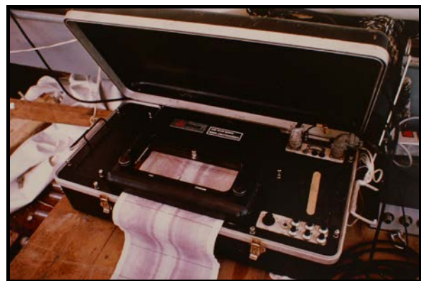
Vermessungsgeräte Track Recorder und Side Scan Sonar Record
