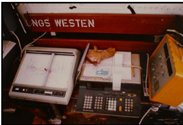
Vermessungsgeräte Track Recorder und Side Scan Sonar Record
