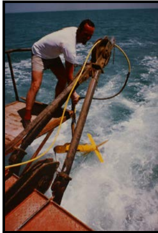
Aussetzen von Bojen, Side Scan Sonar und Baustellenschild
